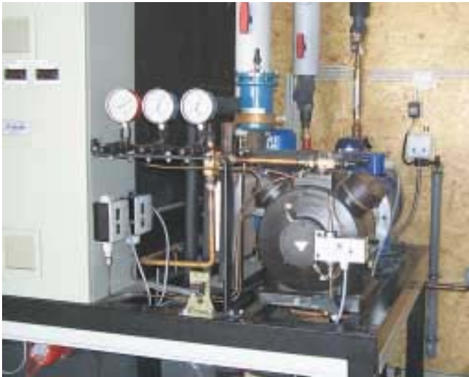
Bild 3 Hubkolbenverdichter Typ O 44 2DK 160, Fabrikat Goeldner, mit angeflanschem Elektromotor
