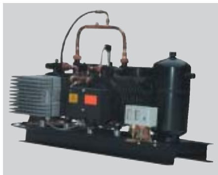
Bild 7: Zweiervorbund, ein statischer und ein geregelter Verdichter
