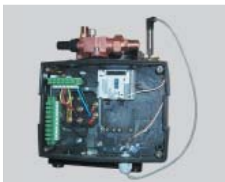
Bild 2: Sockel für FU anstelle des Klemmenkastens am Verdichter
