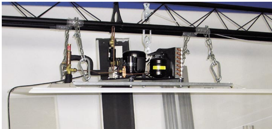
Bild 1 Erster Prototyp einer direktverdampfenden Kühldecke
