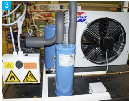
Bilder 2 und 3: Komponenten der Anlage, insbesondere die Explosionsschutzausführungen von Verdichter und Druckschaltern
